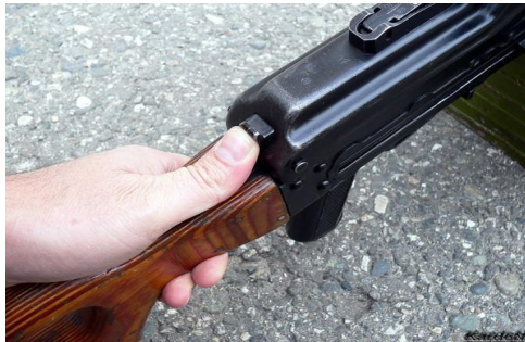
Рисунок 5 – відкривання кришки ствольної коробки кулемета.
