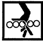
**РУХОМІ ЧАСТИНИ** — рука з пальцями, які потрапили між ролики, вказує на те, що рухомі частини обладнання становлять небезпеку для життя або кінцівок людини.
