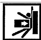
**ВАЖКІ ДЕТАЛІ** — символ у вигляді важкого предмета, який притискає фігуру людини до стіни, вказує на те, що важкі рухомі деталі становлять небезпеку для життя або кінцівок людини.
